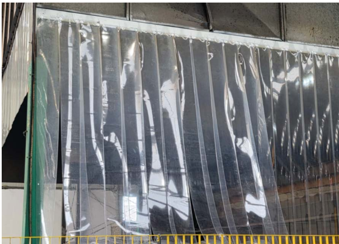
Figura 23: Bandelle in uscita impianto cataforesi
